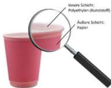
Abbildung 1: Aufbau eines To-Go-Bechers.
