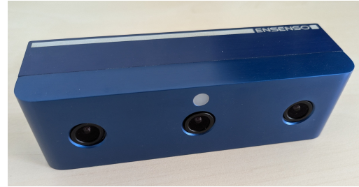
(b) ENSENSO 10 Tiefenkamera, bestehend aus zwei Graustufenkameras sowie IR-Emitter und -Empfänger
