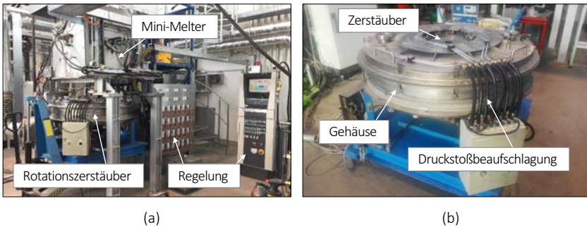
Abbildung C-5.1: Peripherie zur Herstellung von Glasflakes in großem Maßstab, a: Glasschmelzanlage (Mini-Melter), b: Rotationszerstäuber.
