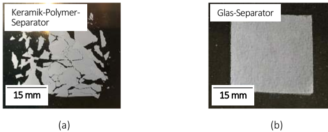
Abbildung C-8.6: Mechanische Integrität von Separatoren nach einer Temperaturbehandlung mit 600 °C für 30 min und nachträglicher, flächiger Belastung mit einem Gewicht (1 kg), a: kommerzieller Keramik-Polymer-Separator (Separion® S240P30), b: selbsttragender Glasvlies/Glasflakes-Komposit-Separator.
