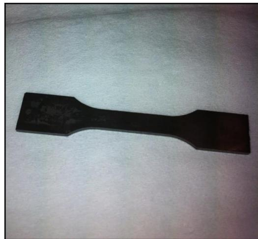
**Abbildung 4.3:** a) Kolbenspritzgussmaschine b) Spritzguss-Probekörper in Form eines Schulterstabes nach EN ISO 527-2:1996
