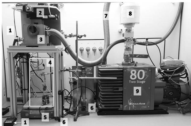
**Abbildung 6-1:** Verwendete Anlage zur aerosolbasierten Kaltabscheidung mit: (1) Drucksensoren, (2) Verfahreinrichtung für den Substrattisch, (3) Beschichtungskammer, (4) Aerosolgenerator, (5) Kreisschüttler, (6) Schwebekörperdurchflussmesser, (7) Wellschlauch, (8) Filter und (9) Vakuumpumpe.
