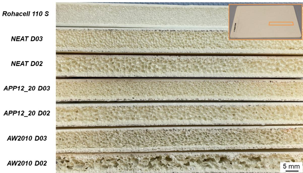
**Abbildung 7.2** Querschnitte von Biegeproben Sandwich-SMC, Ausschnitt: Position in Platten Proben 9 nach **Abbildung 5.5**.
