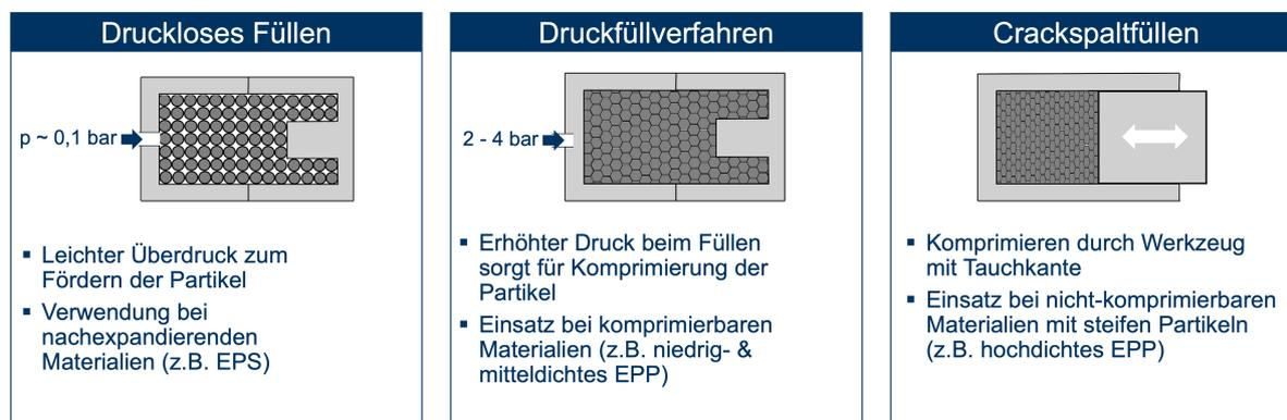
**Abbildung 5.1** – Übersicht der Füllmethoden bei der Formteilherstellung © Neue Materialien Bayreuth GmbH
