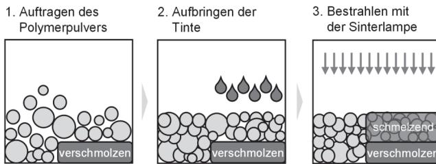
Abbildung 7: Prozessablauf des High Speed Sintering
