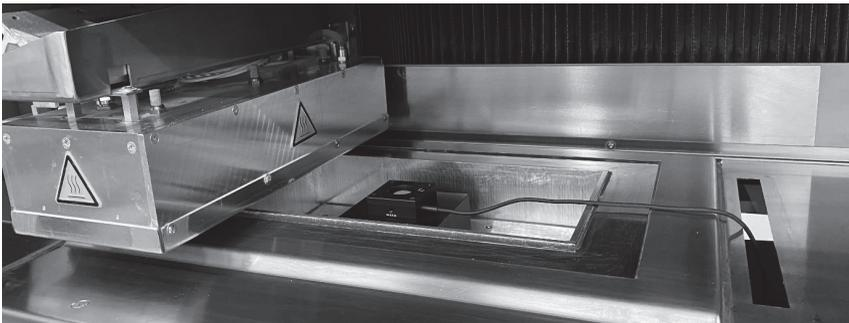
Abbildung 38: Aufbau zur Messung der Flächenenergiedichte in der HSS-Maschine voxeljet VX200 HSS
