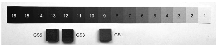
Abbildung 70: Farbabstufung der Dichteprüfkörper mit Graustufe 1, 3 und 5 der rußhaltigen Tinte in Block 2
