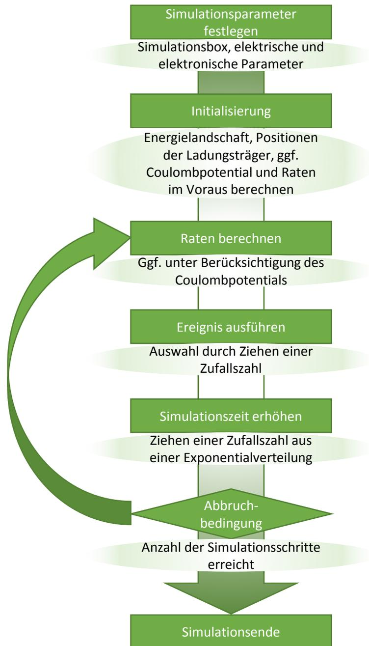
Abbildung 5.2 Ablaufdiagramm einer Monte-Carlo-Simulation zur Modellierung von Ladungstransport.
