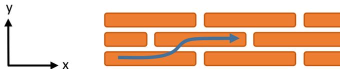
Abbildung 7.13 Schematische Darstellung des Ladungstransportweges bei Oligomeren, die einen Versatz benachbarter Oligomere entlang der  $y$ -Richtung aufweisen. In oranger Farbe sind die Oligomere ange deutet, der blaue Pfeil symbolisiert einen möglichen Weg eines Ladungsträgers.
