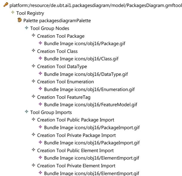
Abbildung 5.15: Das Tooling Definition Model des Paketdiagrammeditors.
