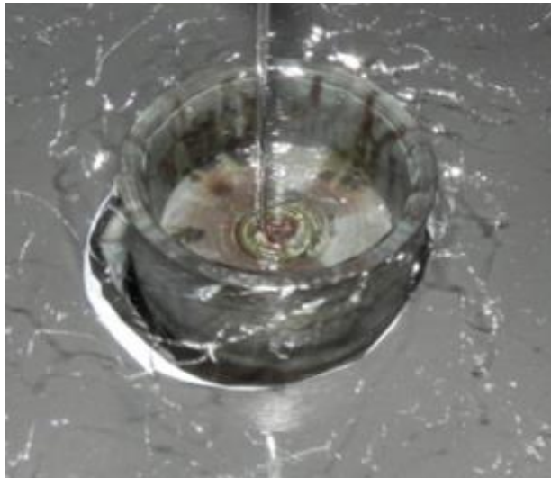
Abbildung 5.2: Die Zerstäubung der Modellflüssigkeit D1000 bei 4000 rpm
