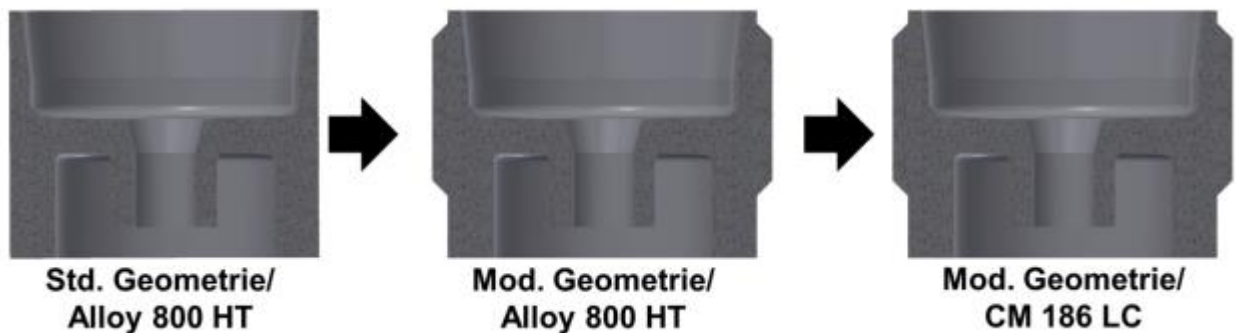
Abbildung 5.16: Für die mechanische Simulation verwendete Zerstäubergeometrien und Materialien: Standard und modifizierte Geometrien
