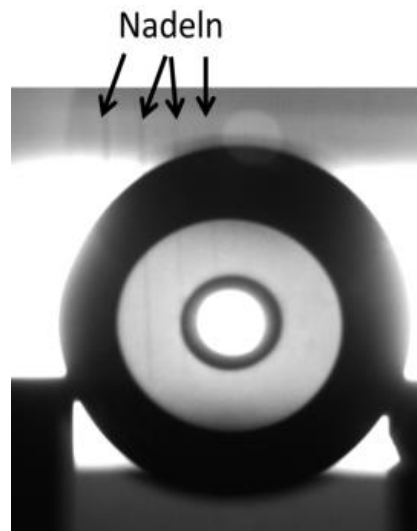
Abbildung 5.25: Röntgenaufnahme des Zerstäubers aus CM186LC (Draufsicht). Im Bild: Prüfnadeln zur vergleichenden Identifikation von Hohlräumen
