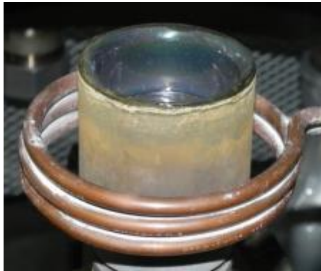
Abbildung 3.8: Der experimentelle Aufbau zur induktiven Erwärmung des Rotationszerstäubers
