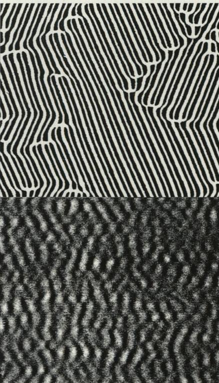
Zwei Momentaufnahmen von Strömungsstrukturen in Flüssigkristallen, das obere Bild zeigt zick-zack-Muster mit großer Strömungsgeschwindigkeit. Die nur schwer sichtbaren Strukturen im unteren Bild wurden dagegen durch die thermische Eigenbewegung der Moleküle hervorgerufen.
