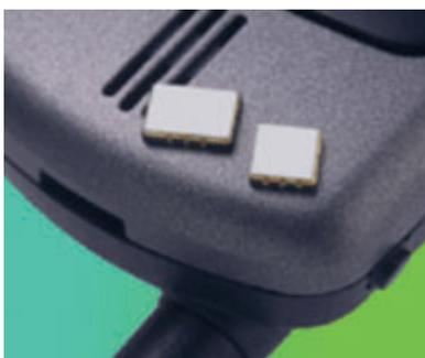
Das mathematische Modell beruht auf der Wellengleichung und dem piezo-akustischen Effekt abhängig von diversen Geometrieparametern wie Länge, Höhe, Anzahl metallischer Lagen. Um elektro-akustische Eigenschaften berechnen zu können, wird die Ladungsverteilung des Bauteils berechnet. Hierdurch kann die totale Interaktion von Reflexion und Durchlassvermögen akustischer Wellen beschrieben werden. Ausgehend von Entwurfszielen werden
