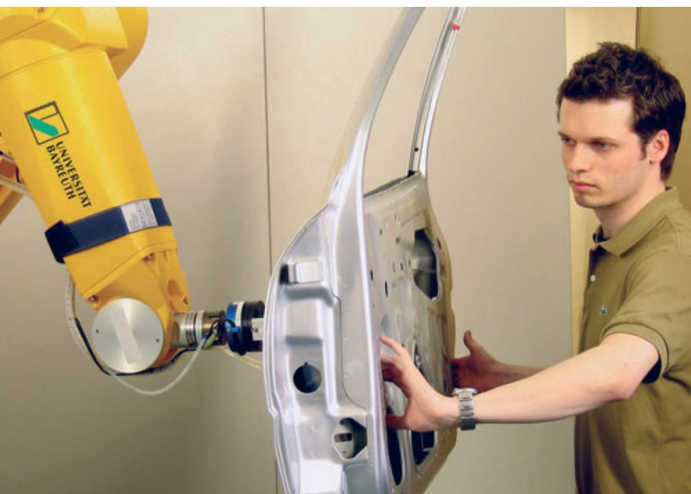
*Sichere Mensch/Roboter-Kooperation durch autonome, kollisionsfreie Roboterbewegungen bei Hol- und Bringdiensten (links) oder durch Halten von schweren Werkstücken mit Führung des Roboters durch den Menschen (rechts)*
