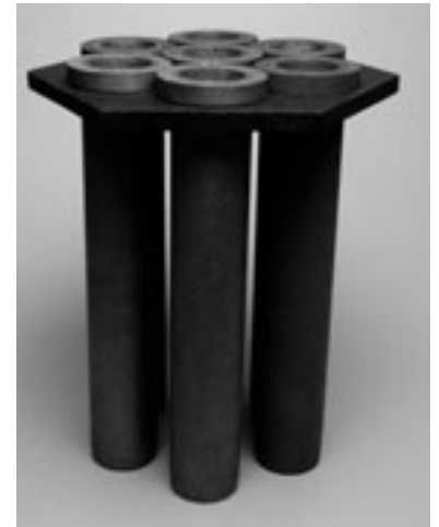
Bild 5: Bauweisen-Studie eines HT-Wärmetauschers aus C/C-SiC-Rohren (DLR)
