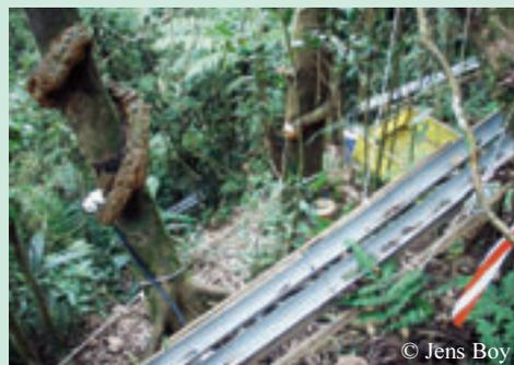
Mit dem "Rutschenpark" sammeln Bodenkundler den Bestandsniederschlag. Durch den Vergleich mit Proben aus Einzelsammeln können sie herausfinden, welche der beiden Methoden repräsentative Werte liefert.
