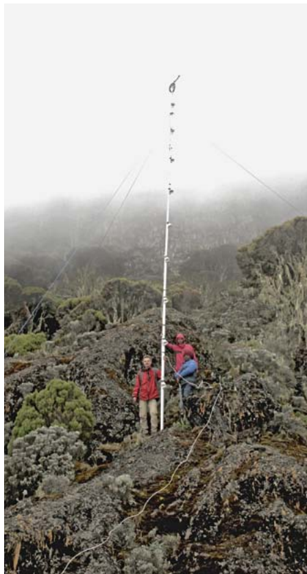
Das Forschungsteam aus Bayreuth baut auf der Untersuchungsfläche auf einer Höhe von 4.000 m einen Mast auf, um durch Messungen ein Klimaprofil zu ermitteln; Foto: Ulf Pommer
