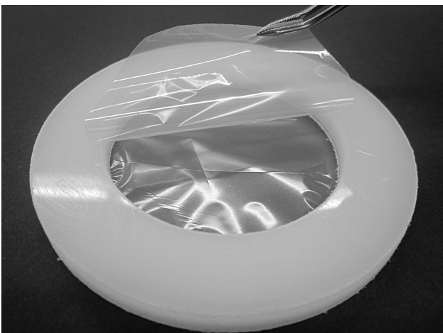
Abbildung 4: Diffusionskammer zur Kultivierung von Umweltmikroorganismen.
