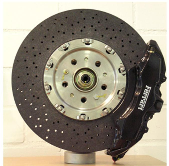
*Bremsscheibe aus Verbundkeramik für Hochleistungsfahrzeuge*
