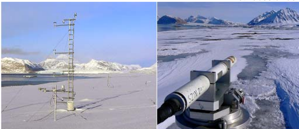
Abb. 3: Links: Meteorologischer Gradientmast (6 m) am 8. Mai 2006 (Foto: Bareiss). Rechts: Sendeeinheit des Laser-Szintillometers am Anfang der gut 100 m langen Messstrecke (Foto: Lüers)
