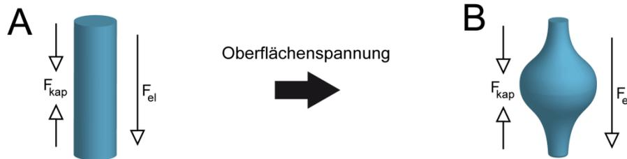
**Abbildung 14:** Auftreten sphärischer Ausprägungen beim elektrostatischen Spinnen: Im Idealfall wird aufgrund elektrostatischer Kräfte  $F_{el}$  eine stabile Strömung des Strahls erreicht, die zu Fasern mit homogenen Durchmessern führt (A). Bei hoher Oberflächenspannung kann es jedoch aufgrund kapillarer Kräfte  $F_{kap}$  zur Kontraktion der Faser kommen, was in Fasern mit sphärischen Ausprägungen resultiert (B).
