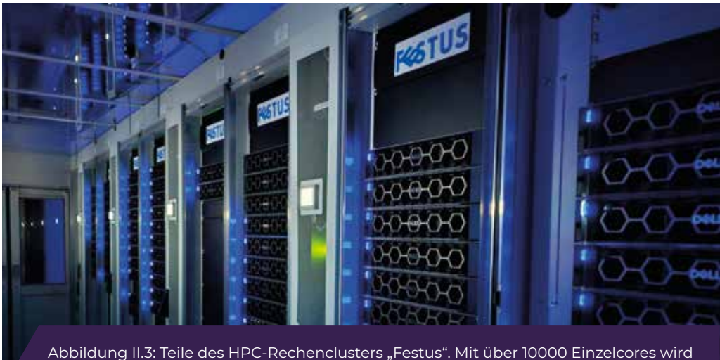
Abbildung II.3: Teile des HPC-Rechenclusters „Festus“. Mit über 10000 Einzelcores wird Festus hauptsächlich für hochgradig parallelisierbare Berechnungen eingesetzt.
