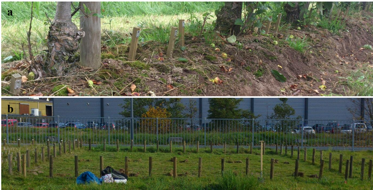
Abbildung 5 Versuchsfelder der Freilandstudie. (a) Holzprüfkörper zwischen den Obstbaumreihen auf der Obstplantage in Norddeutschland; (b) standardisiertes Feld für die Holzprüfkörper in Mitteldeutschland.
