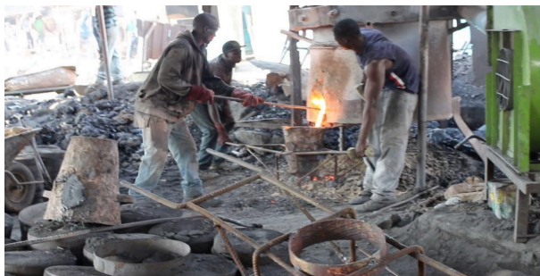
Figura 1: perforación del horno de fundición, llenado del hierro fundido.
