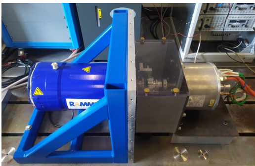
Abb. 4.2: Dreiphasiger Dreipunkt-ANPC Wechselrichter und Prüfstands-Maschine mit angekoppelter Last sowie deren wichtigste Kenndaten.
