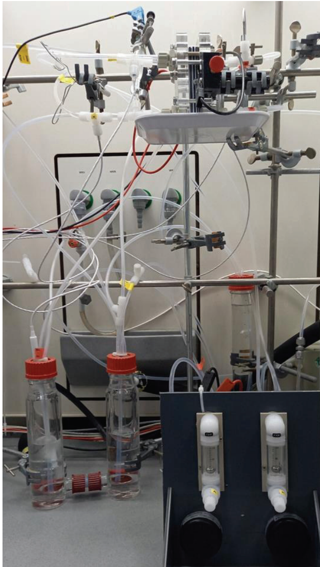
Abbildung A 4: Fotografie der Anlage zur CO 2 -Reduktion an GDEs.
