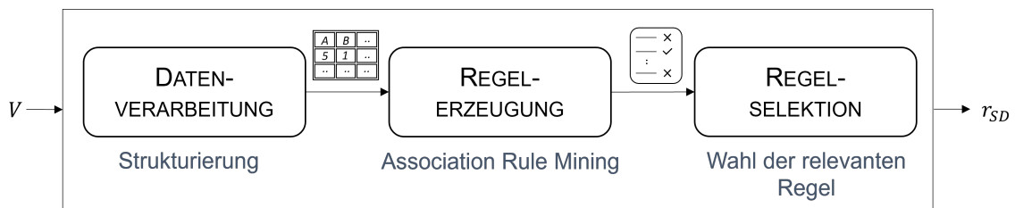
Abbildung 28: Teilschritte zur Umsetzung des Analyseschritts mit Association Rule Mining für strukturierte (Bild-)Daten.
