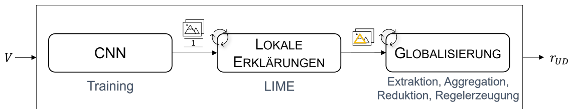
Abbildung 22: Teilschritte zur Umsetzung des Analyseschritts für unstrukturierte Bilddaten mit LIME.
