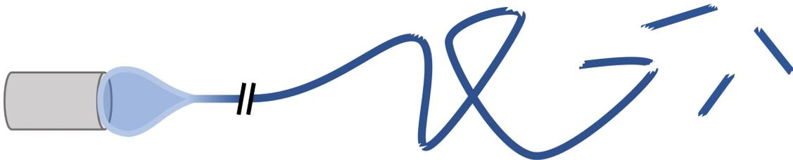
**Abbildung 4.10:** Schematische Darstellung des Polymerstrahls beim Sprödbbruch. Im trocknungsdominierten Bereich erzeugen die Biegeinstabilitäten aufgrund der elektrischen Ladung an der Oberfläche hohe Scherkräfte, die bei ungenügender Faserelastizität zum Sprödbbruch führen.
