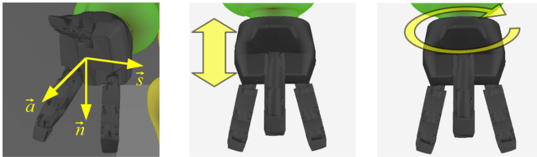
Abbildung 4.2.: Konzeptgrafiken aus [167] zu verschiedenen Varianten für eine Schlüsselgeste zum Öffnen und Schließen des Greifers. Es werden dort kraftbasierte und positionsbasierte Richtungswechsel vorgeschlagen (Mitte), in beliebigen Achsen oder solchen des NSA-Koordinatensystems (links), sowie rotationsbasierte Richtungswechsel (rechts). Letztere Möglichkeit wurde in den Experimenten in der Arbeit verwendet.
