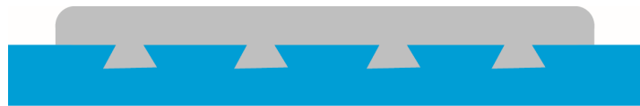
Abbildung 24 Schematische Darstellung der mechanischen Verankerungen von zwei Polymeren. Die Adhäsion wird hier durch Hinterschnitte in einem der Partner (blau) realisiert.
