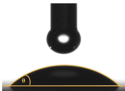
Abbildung 44 Schattenbild eines liegenden Tropfens auf der Substratoberfläche mit dem generierten Kontaktwinkel \theta .
