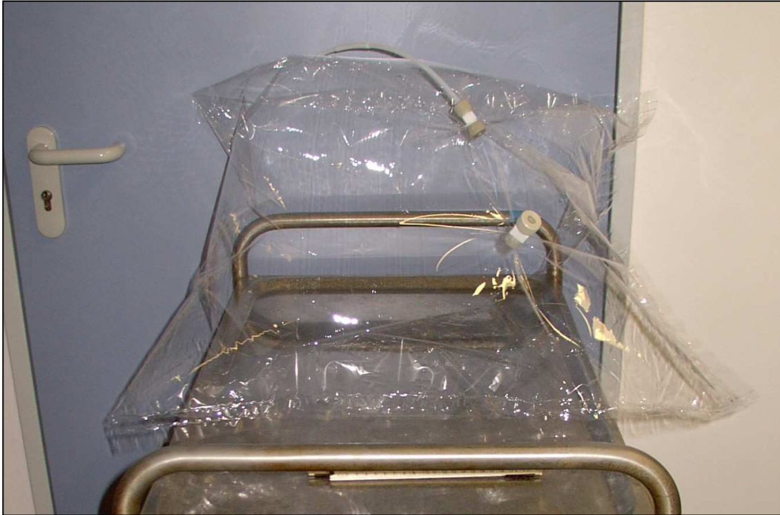
Abbildung 13: Beutel aus FEP-Teflon mit Septum und Gas-Zufuhr
