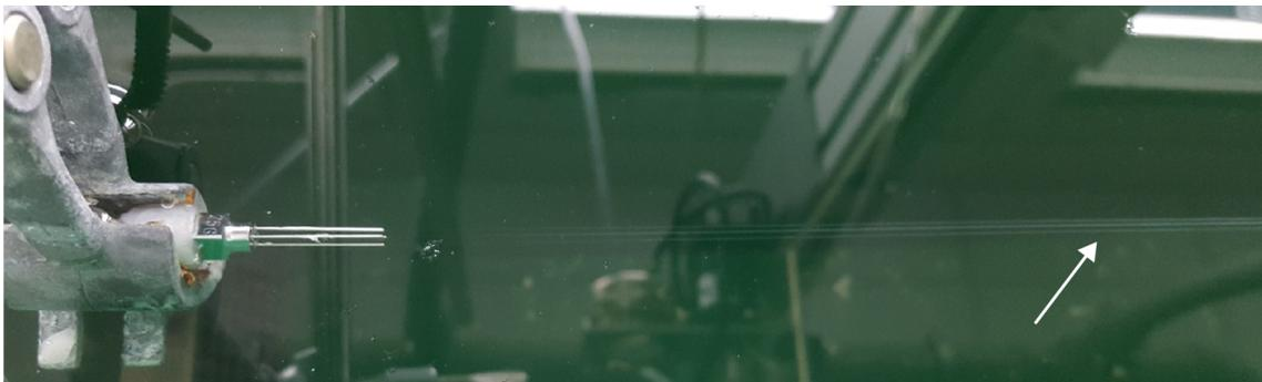
**Abbildung 4.8: Herstellung von Multifilamenten durch Spinnköpfe mit mehreren Kapillaren.** Dargestellt ist der Gradient des ausfallenden CAs entlang der vier parallel produzierten Filamente (Pfeil). Der Volumenstrom der Spinnlösungen betrug pro Filament  $65 \mu\text{l}/\text{min}$ , die Fällbadtemperatur  $15^\circ\text{C}$  und die Aufnahmegeschwindigkeit der Filamente aus dem Fällbad  $3,14 \text{ m}/\text{min}$ .
