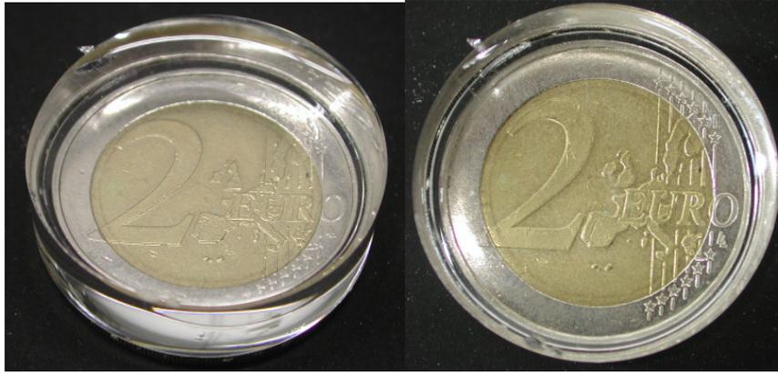
**Abb. 110:** Fotografien eines 6 Wochen an Luft getrockneten PAA-SiO<sub>2</sub>-Gels; jeweils 50wt% TGOS, 35 wt% H<sub>2</sub>O, 15 wt% PAA  $\alpha=0,2$
