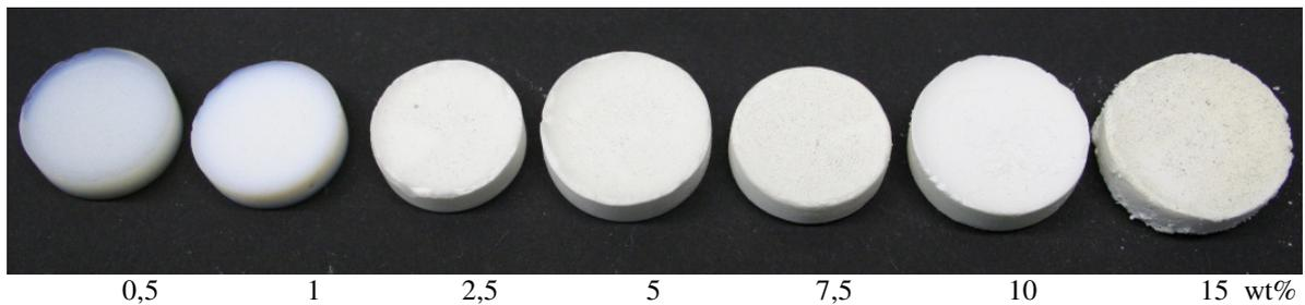
*Abb. 98: Fotografien der getrockneten Aerogele mit steigendem PAA-Gehalt von links nach rechts (0,5% - 15% PAA)*
