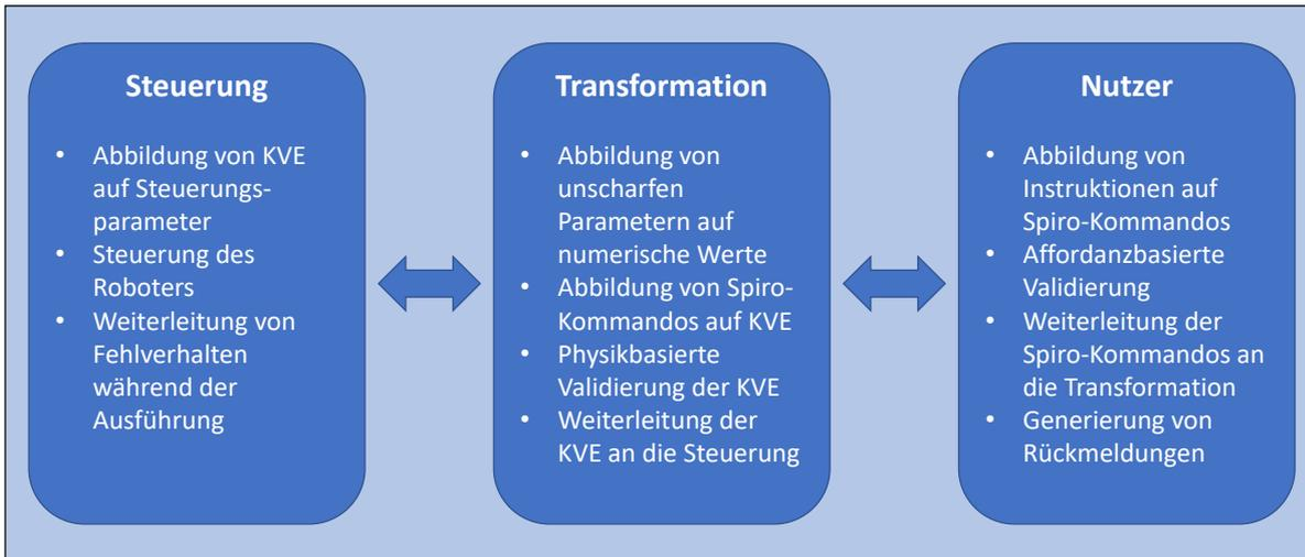
Abb. 8.1: Die drei Hauptmodule des entwickelten Prototyps. Das Hardware-Modul ist für die Ansteuerung des Roboterarms zuständig, das Dialogsystem für die Interaktion mit dem Nutzer und die Hauptanwendung SpiRo für die Validierung und Transformation von Instruktionen in KVEs.
