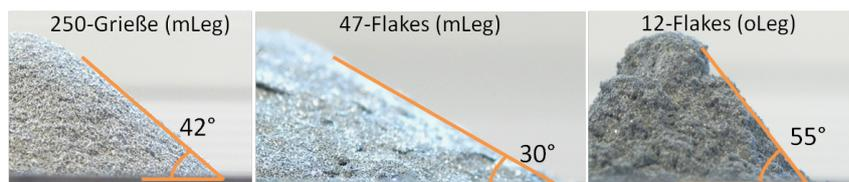
**Abbildung D.0.3.:** Schüttwinkel unterschiedlicher Zinkmorphologien zur Charakterisierung der Rieselfähigkeit; gemessen am LSWV.
