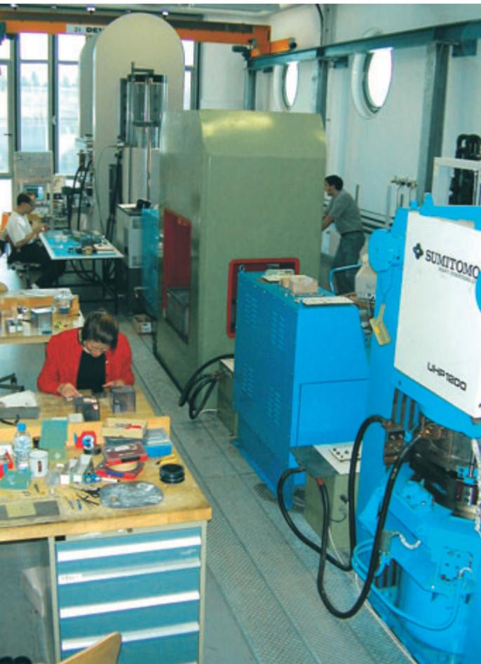
*Ultra-Hochdrucklabor des Bayerischen Geoinstituts: In den 3 Großpressen werden mit bis zu 4500 t Presskraft Zustände des Erdmantels bis in 700 km Tiefe simuliert: Drücke bis zu 25 GPa (250 kbar) und Temperaturen bis 3000° C.*
