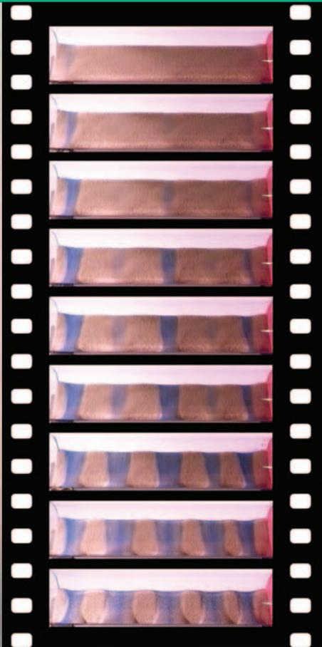
Abb. 2: Erfolgreiches Mischen von Granulaten in einer Mischtrommel ist keineswegs ein zwangsläufiger Vorgang, wie die Bildfolge zeigt. Einfarbige Streifen erscheinen aus dem Nichts. In der ursprünglich homogenen Mischung zweier Sande erfolgt Korngrößentrennung aufgrund von Instabilitäten.
