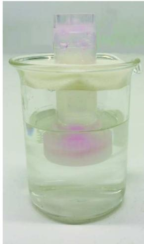
**Abbildung 2.5:** Dialyse der wässrigen Partikellösung in Methanol: Durch eine Filtermembran getrennt befinden sich innerhalb des hier eingesetzten Tube-O-DIALYZERS die wasserverdünnte Partikellösung und außerhalb im Becherglas das Methanol. Der Dialyseprozess wurde über Nacht laufen gelassen, wobei grundsätzlich versucht wurde, die Kontaktzeit mit Kunststoffgefäßen zu minimieren.
