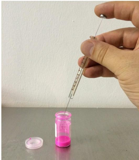
**Abbildung 2.4:** Deckelglas mit der umgefüllten wässrigen Partikellösung: Die Entnahme der Kleinstmengen erfolgte mit einer Hamilton-Spritze.
