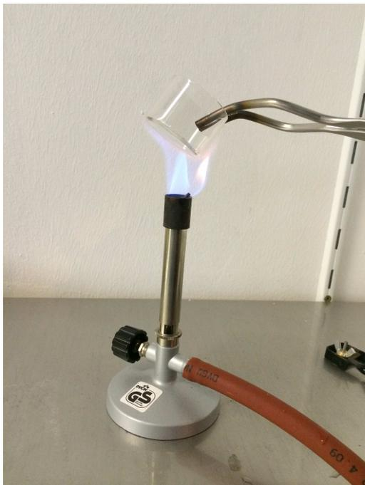
**Abbildung 2.6:** Gewöhnlicher gasbetriebener Bunsenbrenner zum Ausbrennen der im Experiment eingesetzten Glasgefäße und Metallgegenstände
