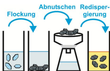
Abbildung 57: Abnutschen und Redispergieren im organischen Lösemittel
