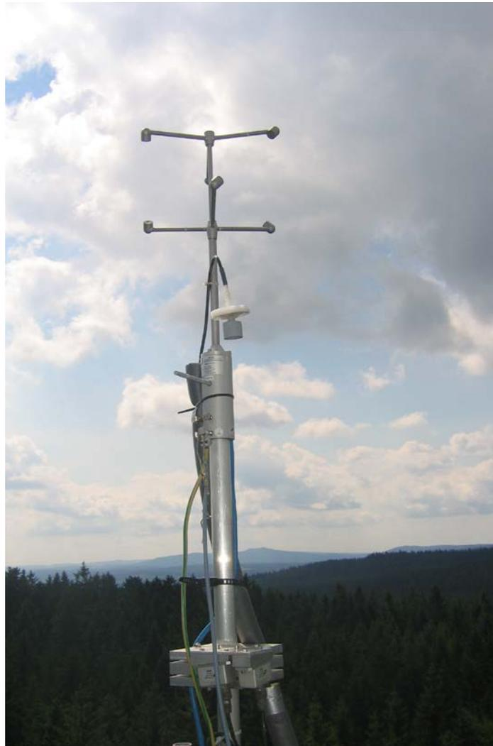
Abb. 39: Messsystem zur Bestimmung der Kohlendioxid- und Wasserdampf Flüsse an der Station Waldstein-Weidenbrunnen (31-m-Hauptturm) bestehend aus einem Ultraschallanemometer und einem Luftansaugstutzen des wenige Meter entfernt stehenden Gasanalysators.
