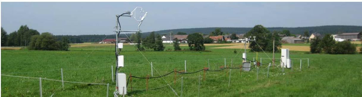
Abb. 3: Klimastation Voitsumra (Hintergrund) mit Eddy-Kovarianz-Mast zur Bestimmung der Verdunstung und des Kohlendioxidaustausches. Der Schaltschrank (inkl. Stromzufuhr) befindet sich in der hinteren rechten Ecke des Messfeldes (Norden), oberes Egertal westlich von Weißenstadt.
