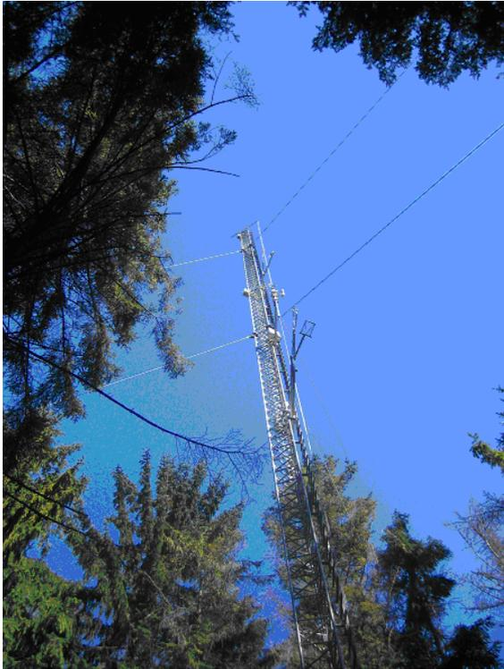
Abb. 1: Messmast zur Bestimmung der Waldverdunstung und des Kohlendioxidaustausches.
